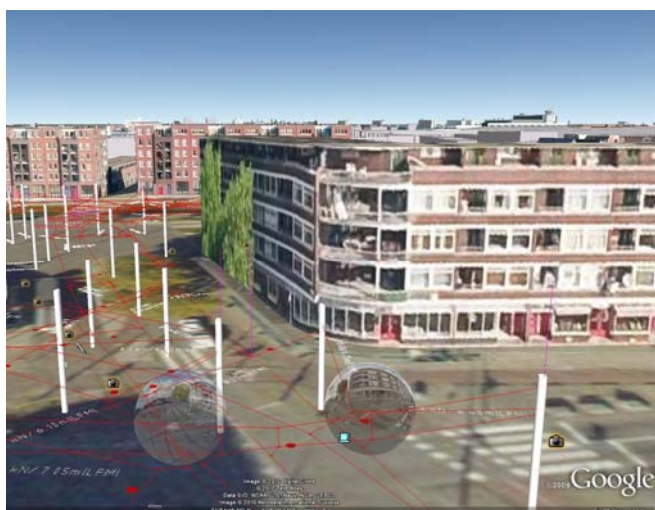
Bild 8: Visualisierung einer Fahrleitungsanlage in Google Earth
